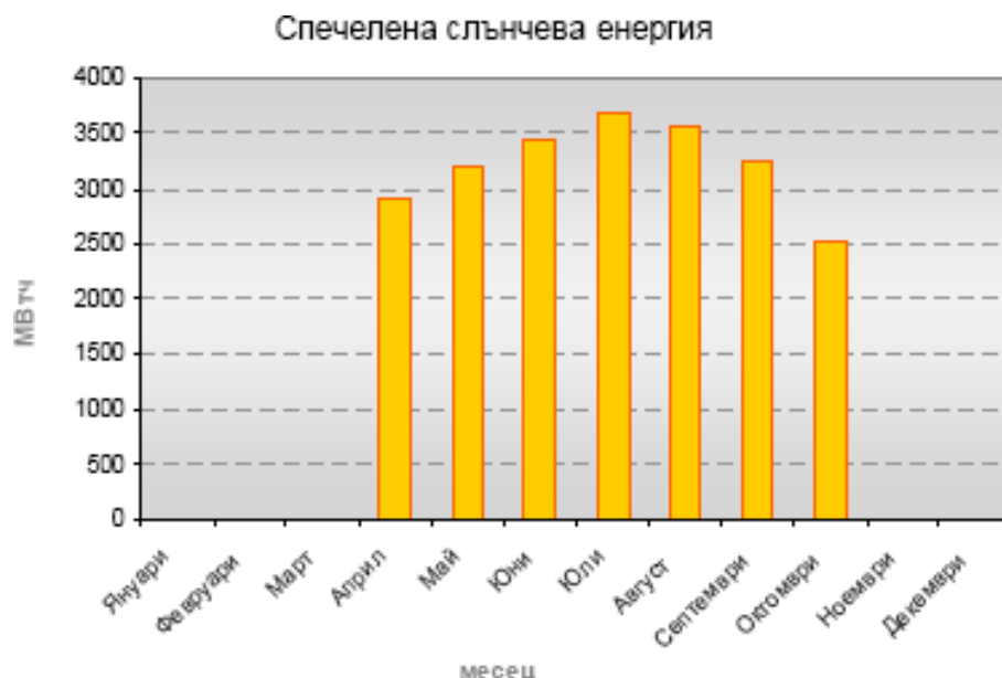
Фиг. 15: Разпределение на възможната за оползотворяване слънчева енергия по месеци при сезонна работа на инсталациите
